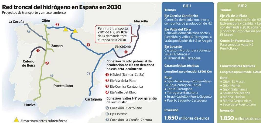
Figura 5. Red troncal del hidrógeno en España en 2030.
