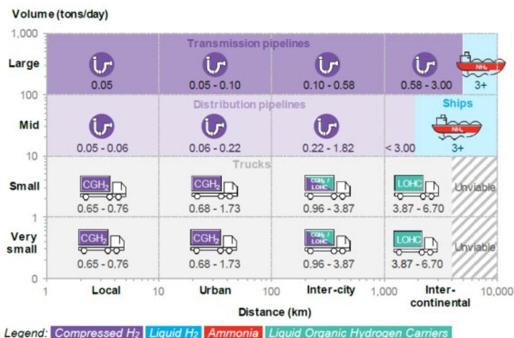
Figura 13. Costes de transporte de hidrógeno en función del volumen y la distancia recorrida (\$/kg). Fuente: Bloomberg NEF. *Hydrogen Economy Outlook*. [10]
