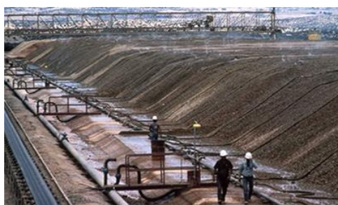
Ilustración 30. Lixiviación en pilas en Ortiz Gold mine (Santa Fe. Nuevo México).
