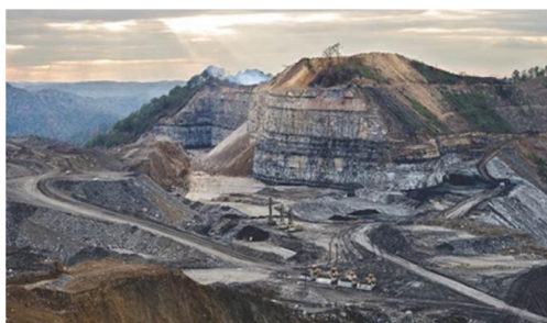
Ilustración 26. Explotación de carbón por minería de contorno en los Apalaches (EEUU).
