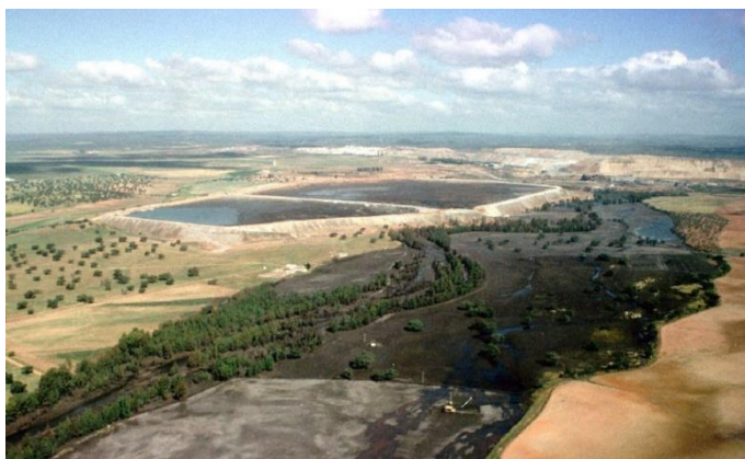
Ilustración 41. Vista aérea del vertido de la balsa minera sobre el río Guadiamar.
