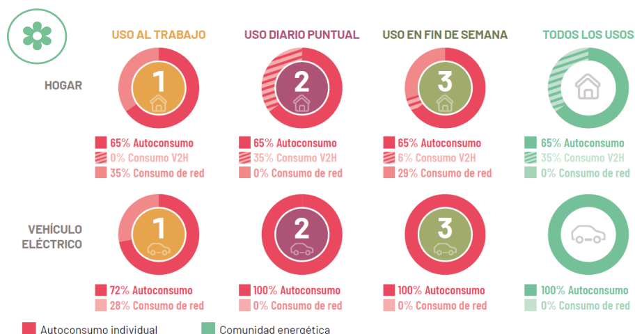
Figura 17. Cobertura en primavera del consumo total (carga del vehículo y consumo del hogar) distribuido en autoconsumo, V2H y red.
