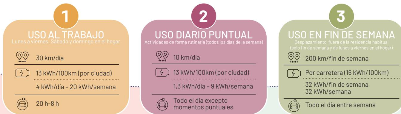
Consumo del vehículo eléctrico cubierto con los excedentes del autoconsumo según el tipo de uso: **trabajo, puntual, fin de semana**
