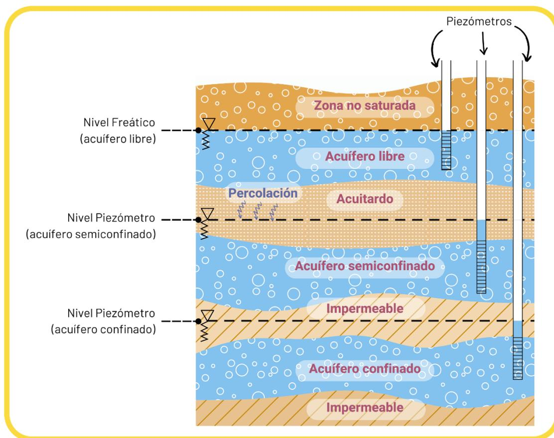
Figura 10. Diferentes tipos de acuíferos según la permeabilidad del material geológico que los contiene.
