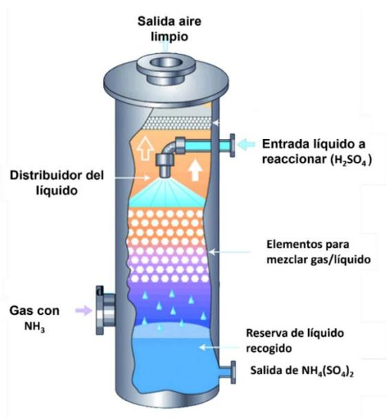
Figura 28. Funcionamiento de un lavador de gases cuando el aire de entrada presenta  $\text{NH}_3$ .
