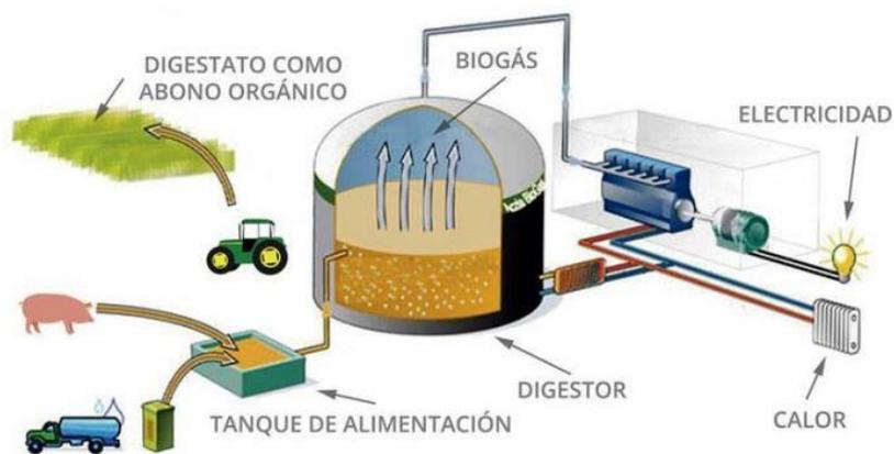
Figura 23. Esquema simplificado del procedimiento para obtener biogás a partir de las deyecciones ganaderas.
