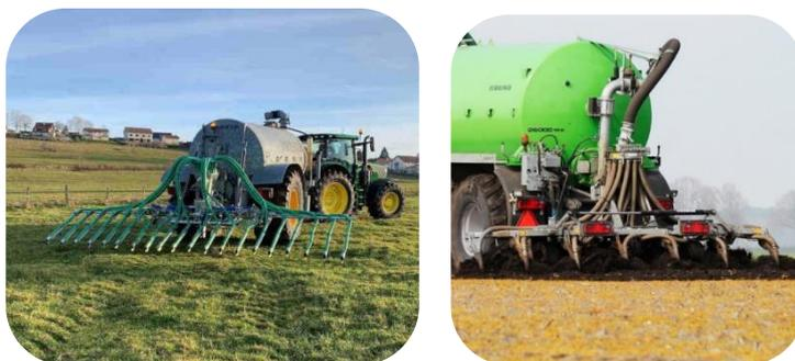
Figura 31. Sistemas de tubos colgantes y enterradores para la aplicación de purines.
