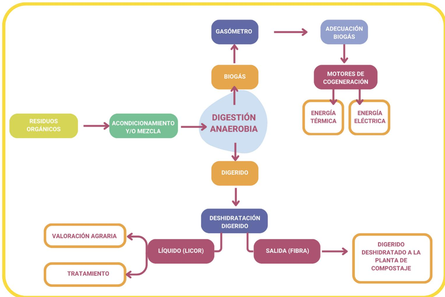
Figura 38. Esquema de las etapas implicadas en la digestión anaerobia y recursos obtenidos.
