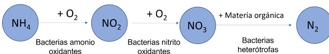
Figura 42. Reacciones en cadena que tienen lugar en el proceso de nitrificación – desnitrificación.
