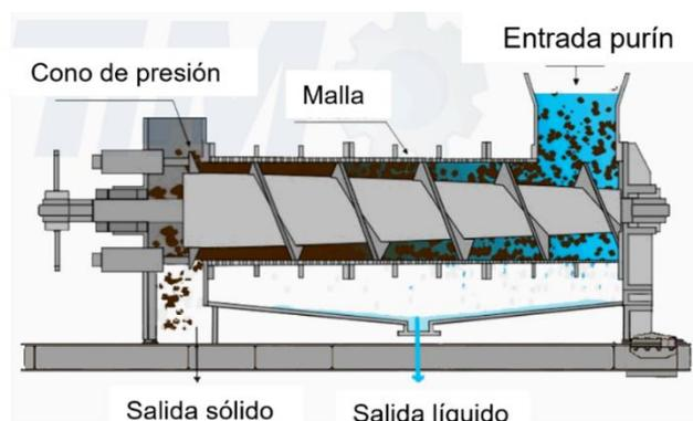
Figura 34. Filtro prensa de tornillo sin fin.
