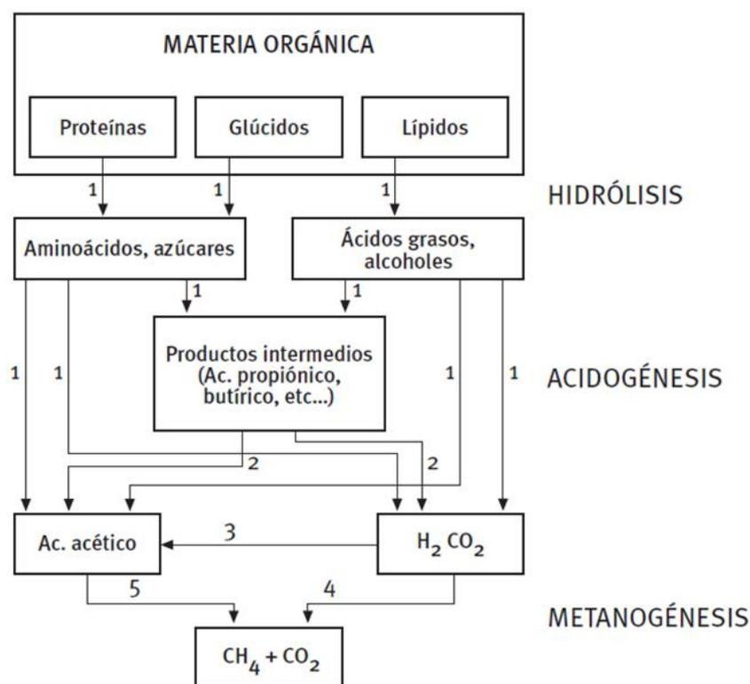
Figura 44. Diagrama de procesos de la digestión anaerobia.
