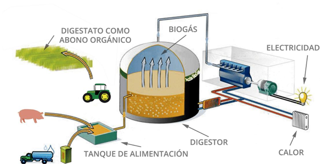
Figura 48. Esquema simplificado de la digestión anaerobia.
