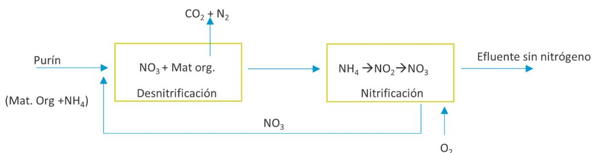
Figura 43. Esquema de un reactor de nitrificación – desnitrificación.
