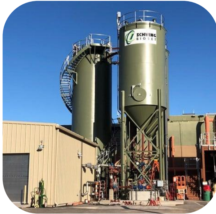
Figura 49. Cristalizador a escala industrial. Fuente: Bioset.
