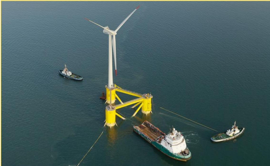
Figura 16. Ilustración del remolque a mar abierto de uno de los aerogeneradores en las plataformas flotantes.
