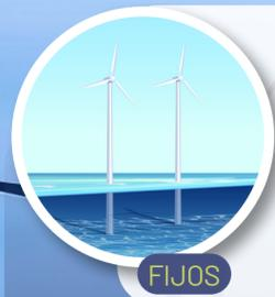
Los parques marinos se construyen, en aguas poco profundas cercanas a la costa, anclando los aerogeneradores al lecho marino, o en instalaciones flotantes en aguas más profundas (superiores a 50 metros, actualmente).
