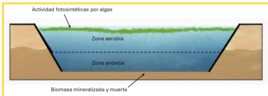
Figura 31. Esquema de un lagunaje facultativo. Fuente: elaboración propia.
