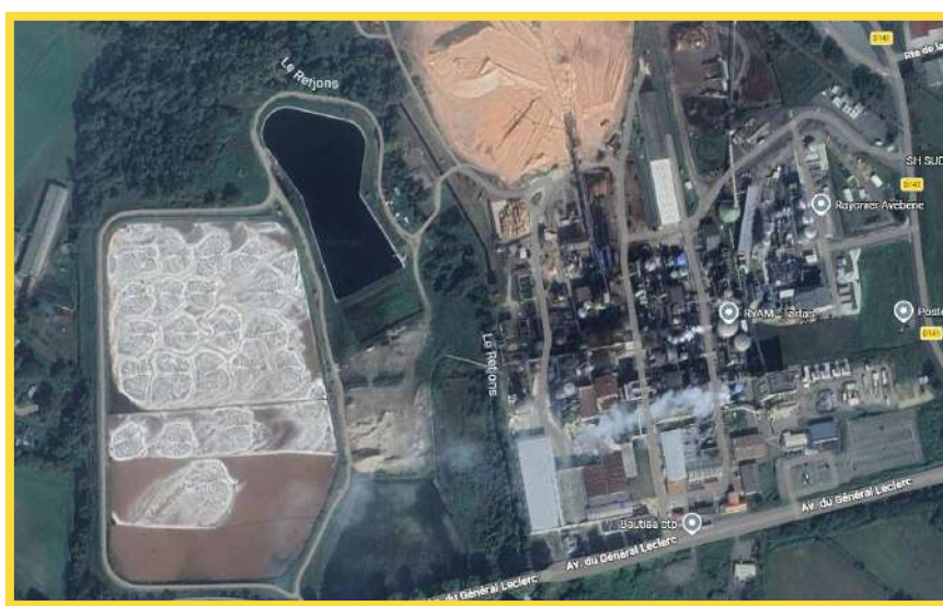
Figura 32. Laguna facultativa aireada de la planta de celulosa en Tartas (Francia), donde se puede apreciar la espuma y las burbujas en su superficie. En la derecha de la imagen se aprecia el tamaño de la instalación industrial. Fuente: Google Maps.
