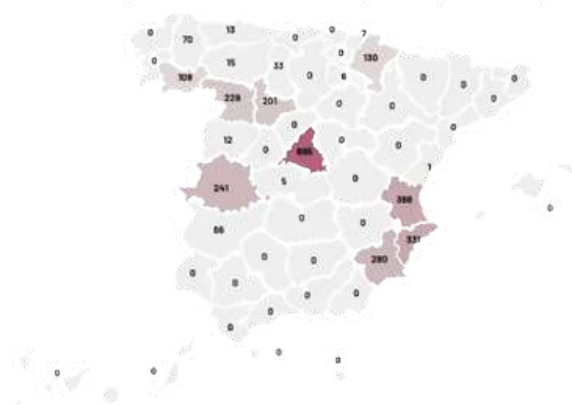
Iberdrola Capacidad de acceso a la demanda disponible septiembre 2025 (MW)
